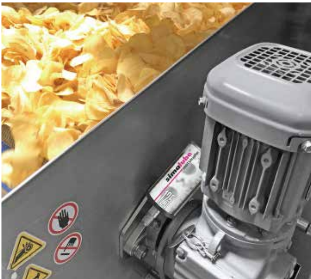
上昇コンベアの駆動装置におけるフランジベアリングの潤滑
