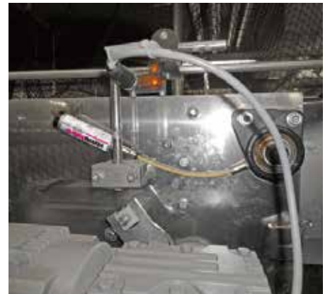
フランジベアリングへのシマルーベ15 取付例
