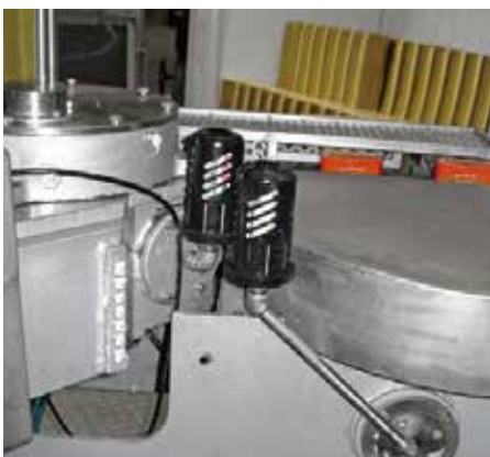
缶詰充填ユニットのロータリーテーブル への取付例 オプションパーツの保護カバー付
