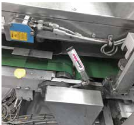
ポテトチップスの生産ラインにおける ドライブローラーへの取付例
