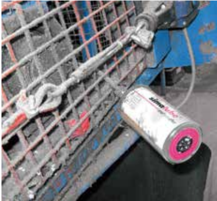
装置の外側より遠隔にて取り付けられた例 ダストシールの役割を果たしている
