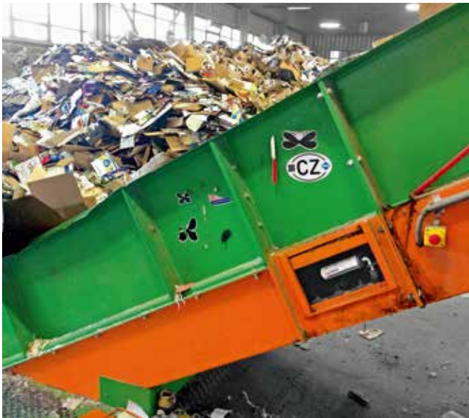
分別ラインのコンベアーチェーンへのシマルーベ250と ブラシ取付例（オイル潤滑とチェーン清掃のため）
