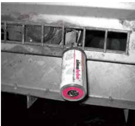
コンベアーベルトのベアリングへの シマルーベ125取付例
