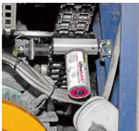
チェーンへの給油でブラシと一緒に取り付けられた例
