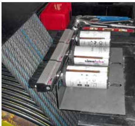
潤滑と清掃の目的でケーブルへ取り付けられたオイル入りシマルーベ125とブラシ
