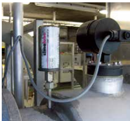
短管を使用して取り付けられたシマルーベ125
