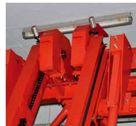
バースクリーンのチェーンへブラシと一緒に取り付けられた例
