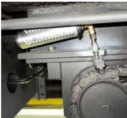
レールクレーンのドライブチェーンへのシマルーベ250とブラシ取付例（オイル仕様）
