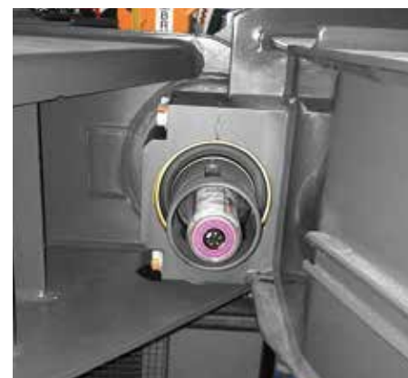
車両のカップリング部へのシマルーベ125取付例
