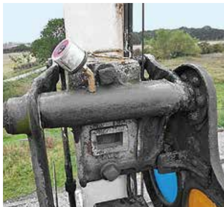
踏切装置のベアリングへのシマルーベ30取付例
