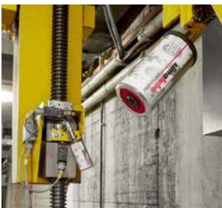
列車用の昇降ステーションのスピンドル部へのシマルーベ125取付例
