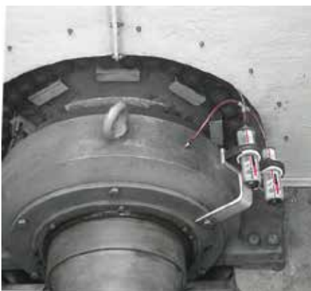
風力発電機のメインベアリングへのシマルーベ250取付例
