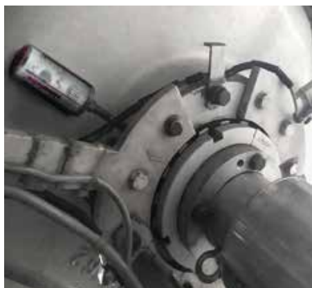
専用のオプションパーツを使って発電機のある所にシマルーベの取り付けが可能
