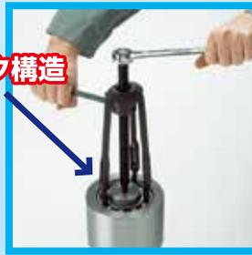
ベアリングの内輪と外輪の間にアームをロックする新構造により、ハウジングとシャフトの間に組み込まれたボールベアリングが簡単に取り外せます
