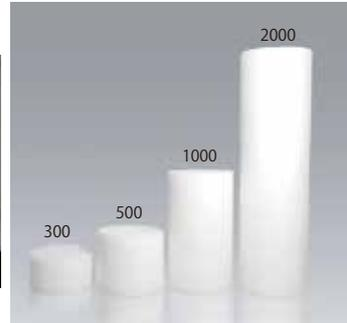
スペック 材質：難燃性ポリエステル、耐熱温度：110℃、初期圧損：47 Pa at 25 m/sec、捕集効率：71%
